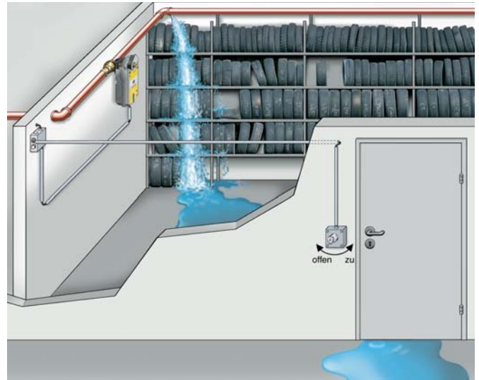
Absperrung des KHS-VAV-plus bei verschlossener Tür mittels Schlüsselschalter
